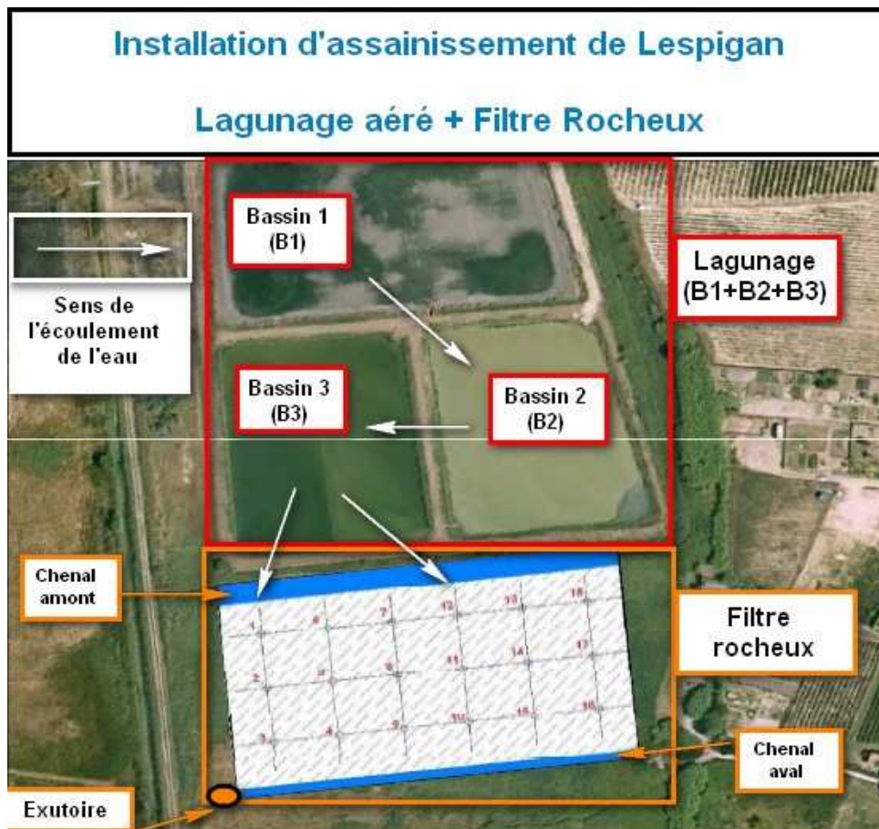
Figure 1 : schéma du rockfilter et référencement des points de prélèvement et contrôle.
