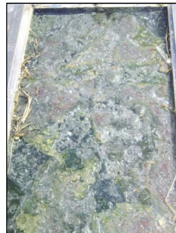
Floc algal et bactérien en surface d'un module
