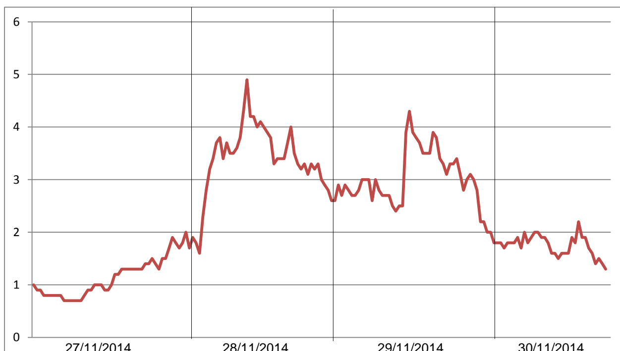
Figure 1 : H 1/3 (ou Hs) en mètres au houlographe de Sète lors du coup de mer de Novembre 2014 (données CANDHIS)
