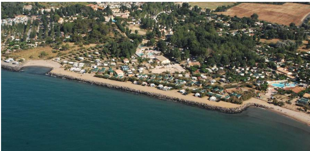
Figure 32 : Vue aérienne des enrochements protégeant les infrastructures sur le secteur de Vias ouest (image aérienne EID/CD34 2018)
