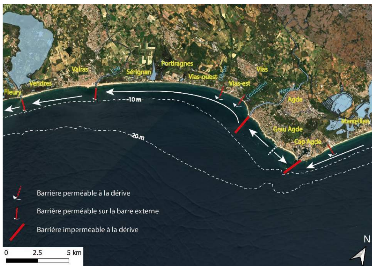
figure 4 : localisation des obstacles à la dérive permettant de découper le littoral en cellules homogènes
