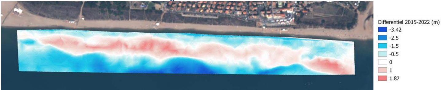
figure 19 : évolution du relief bathymétrique entre 2015 et 2022 sur le secteur de Portiragnes sources Orthophoto IGN et DREAL, 2015 – images Pléiades 2020 (IGN/CNES/AIRBUS)
