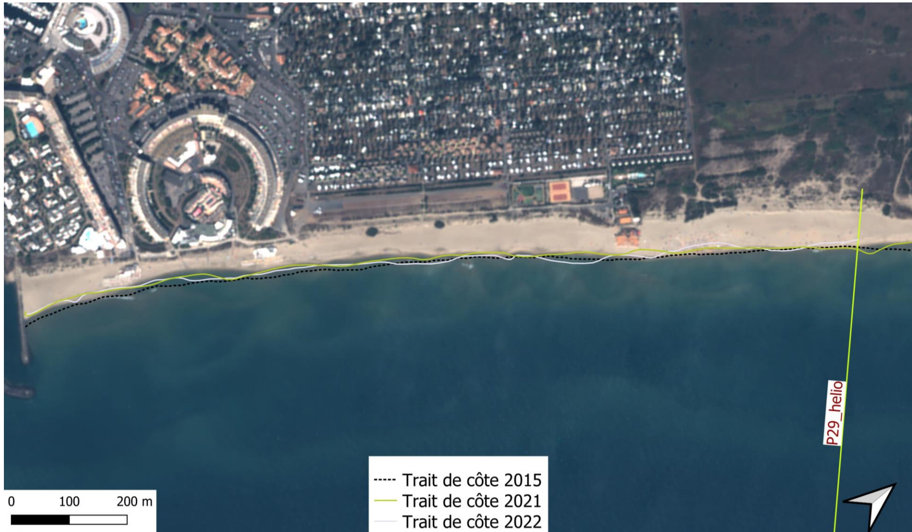
Figure 75 : Variations du trait de côte entre 2015 (pointillé), 2020 (position du trait de côte visible sur l'image), 2021 (jaune) et 2022 (bleu) sur la partie est du secteur 9 (orthophotographie Pléiades 2020)
