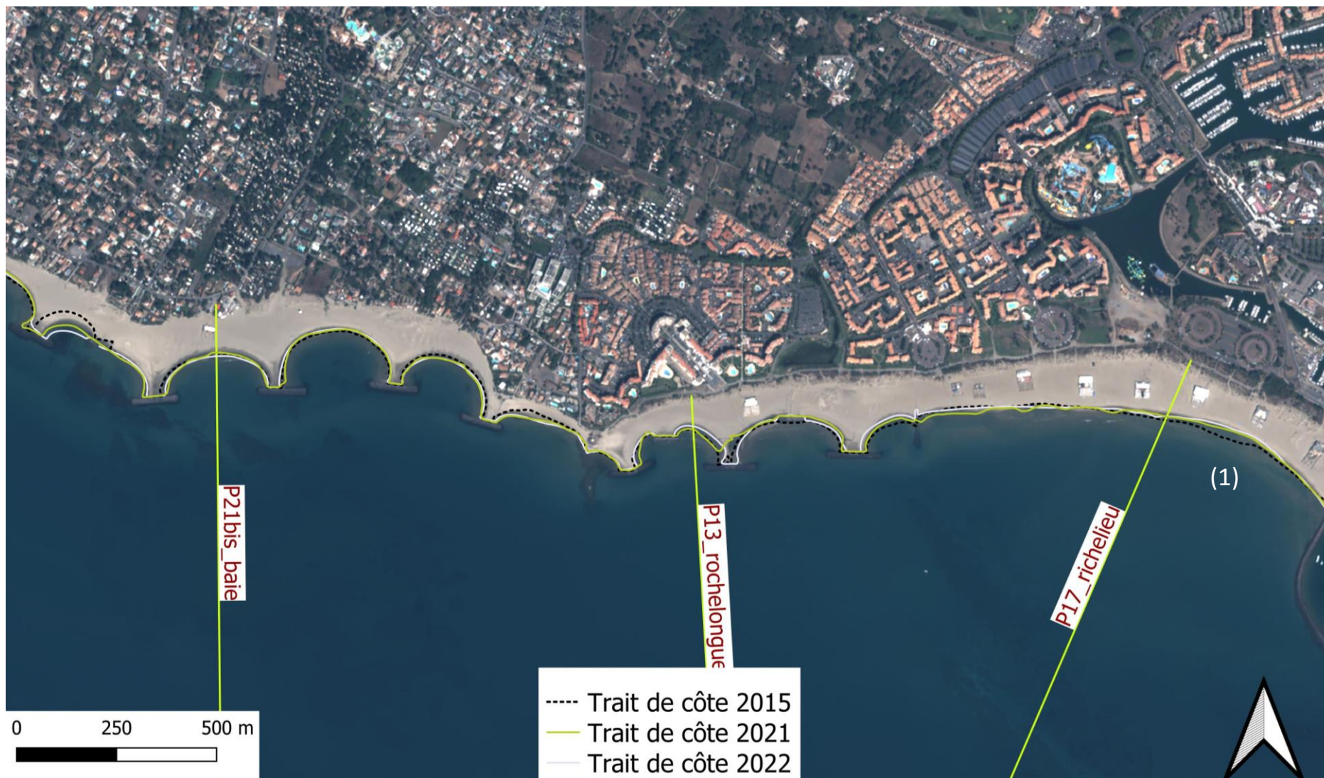
Figure 64 : variations du trait de côte entre 2015 (pointillé), 2020 (position du trait de côte visible sur l'image), 2021 (jaune) et 2022 (bleu) sur le secteur 8 (orthophotographie Pléiades 2020)
