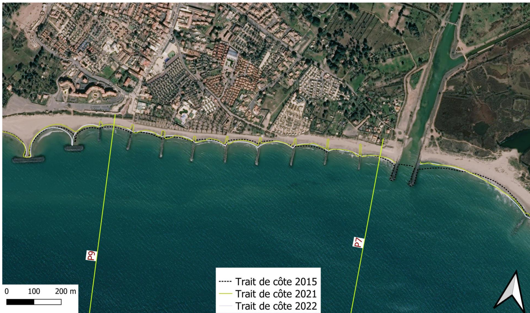
Figure 57 : variations du trait de côte entre 2015 (pointillé), 2020 (position du trait de côte visible sur l'image), 2021 (jaune) et 2022 (bleu) sur a partie ouest du secteur 7 (orthophotographie Pléiades 2020)
