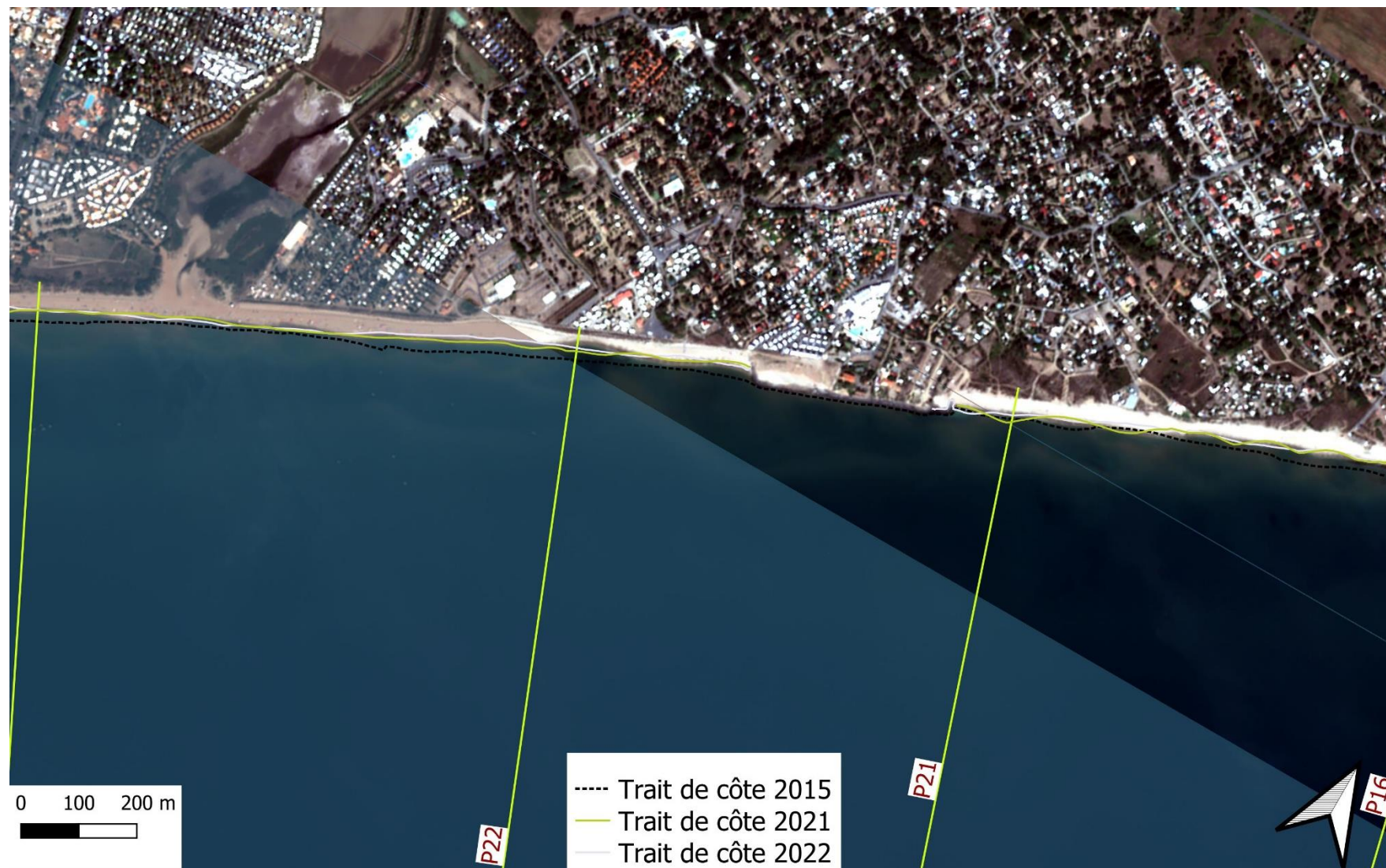
Figure 46 : variations du trait de côte entre 2015 (pointillé), 2020 (position du trait de côte visible sur l'image), 2021 (jaune) et 2022 (bleu) sur a partie ouest du secteur 6 (orthophotographie Pléiades 2020)
