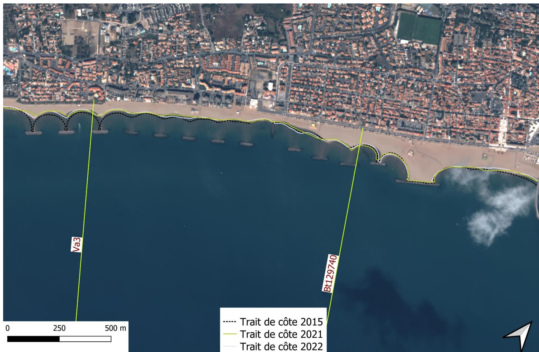
Figure 17 : variations du trait de côte entre 2015 (pointillé), 2020 (position du trait de côte visible sur l'image), 2021 (jaune) et 2022 (bleu) sur le secteur 2 (orthophoto Pléiades 2020)
