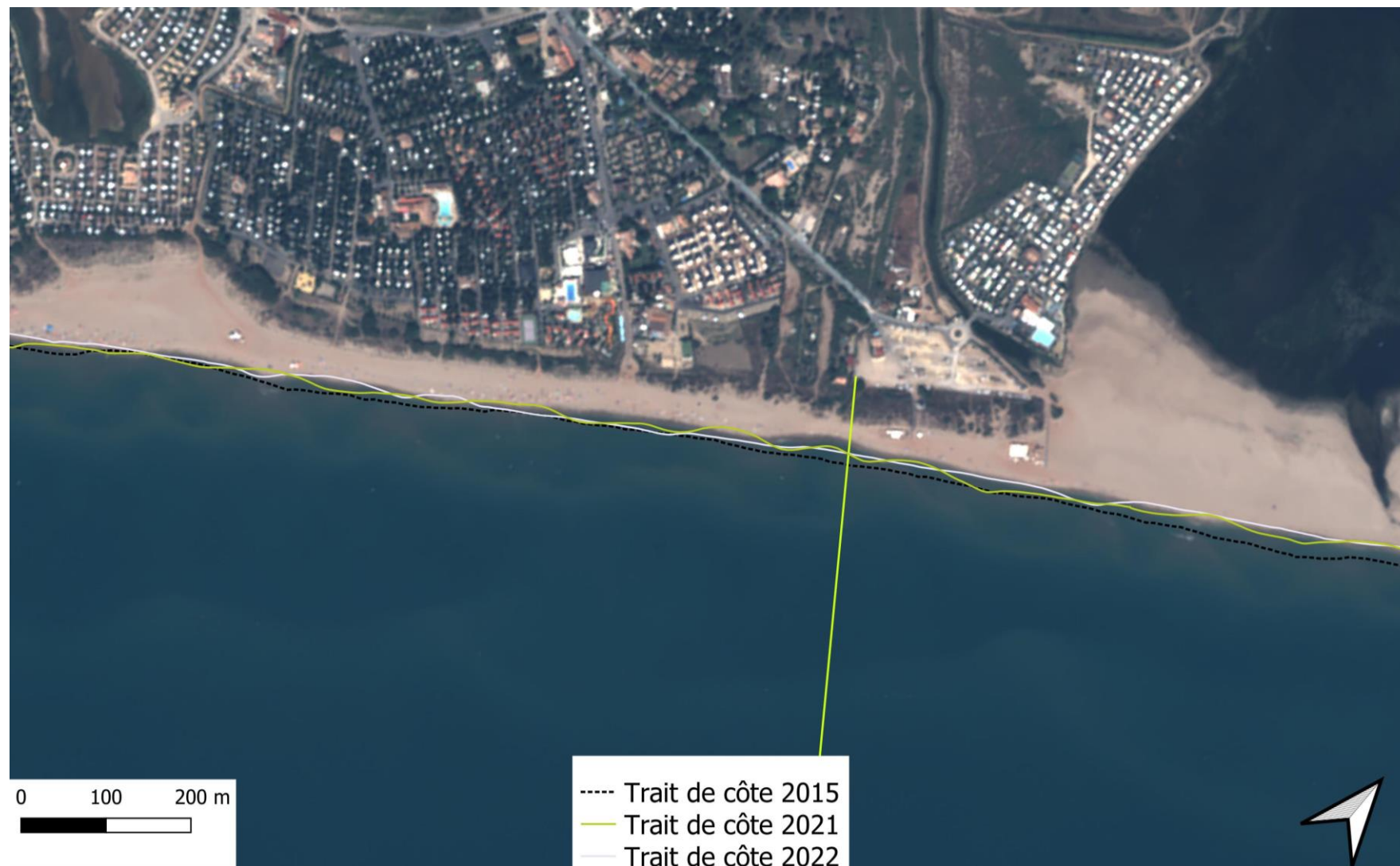
Figure 30 : variations du trait de côte entre 2015 (pointillé), 2020 (position du trait de côte visible sur l'image), 2021 (jaune) et 2022 (bleu) sur la partie est du secteur 4 (orthophotographie Pléiades 2020)
