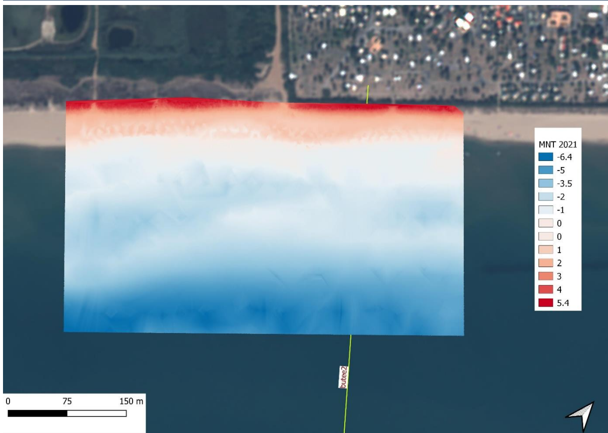
Figure 14 : Représentation du relief sur le MNT à la limite communale entre Vendres et Valras, pour le Lidar 2015 (haut) et les levés terrain de 2021 (bas)
