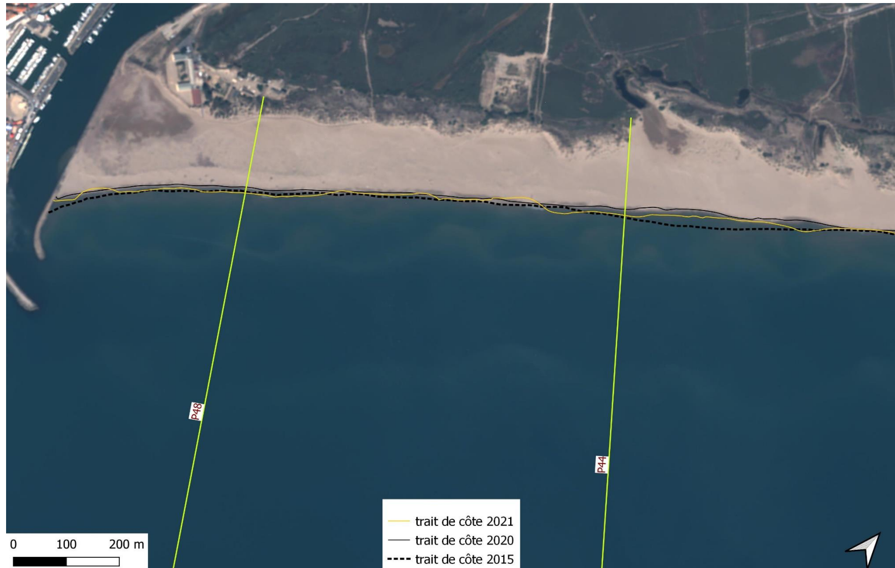
Figure 26 : ortho-image Pléiades de 2020 sur la partie Valras de la zone naturelle des Orpellières, permettant de comparer l'évolution du trait de côte entre 2015 (pointillé), 2020 (noir) et 2021 (jaune)
