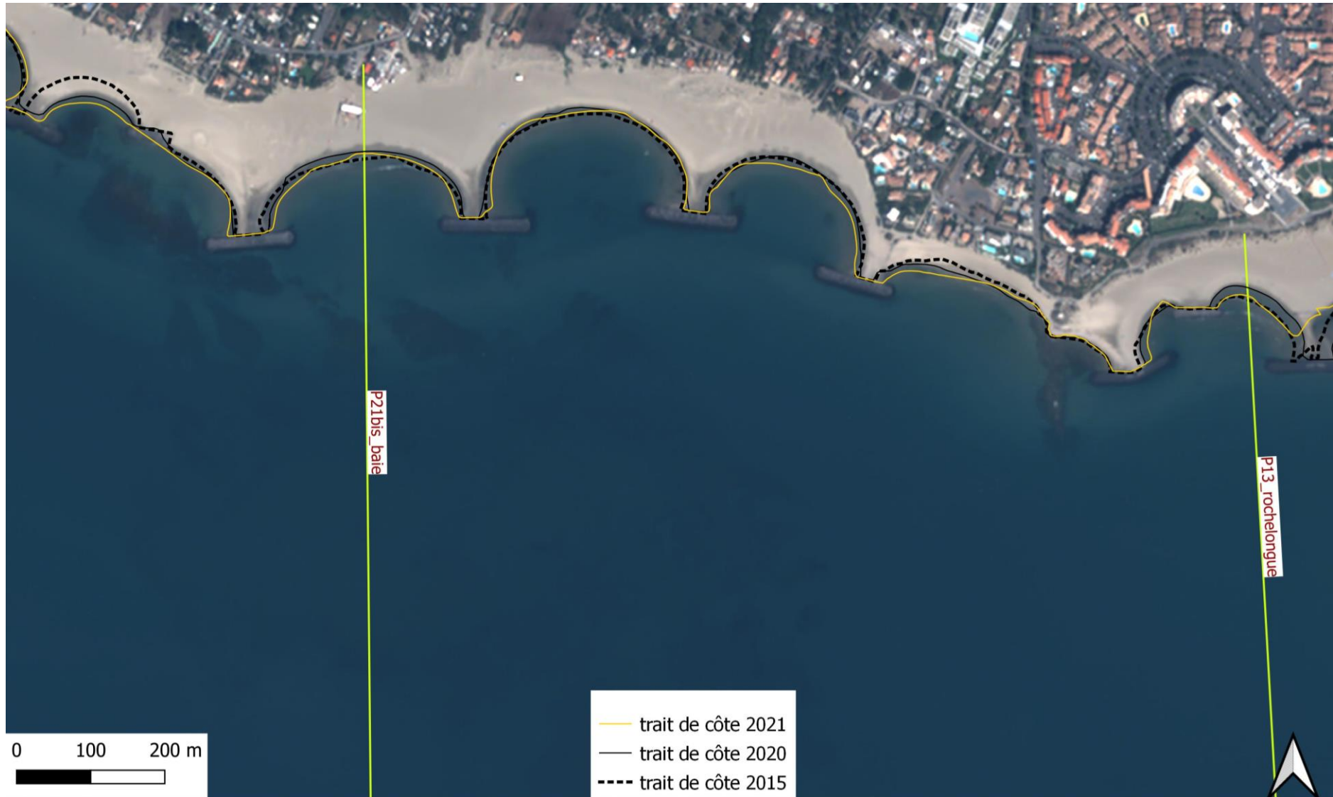
Figure 69 : ortho-image Pléiades de 2020 au niveau de la pointe et de la plage de la plage de Rochelongue, permettant de comparer l'évolution du trait de côte entre 2015 (pointillé), 2020 (noir) et 2021 (jaune)
