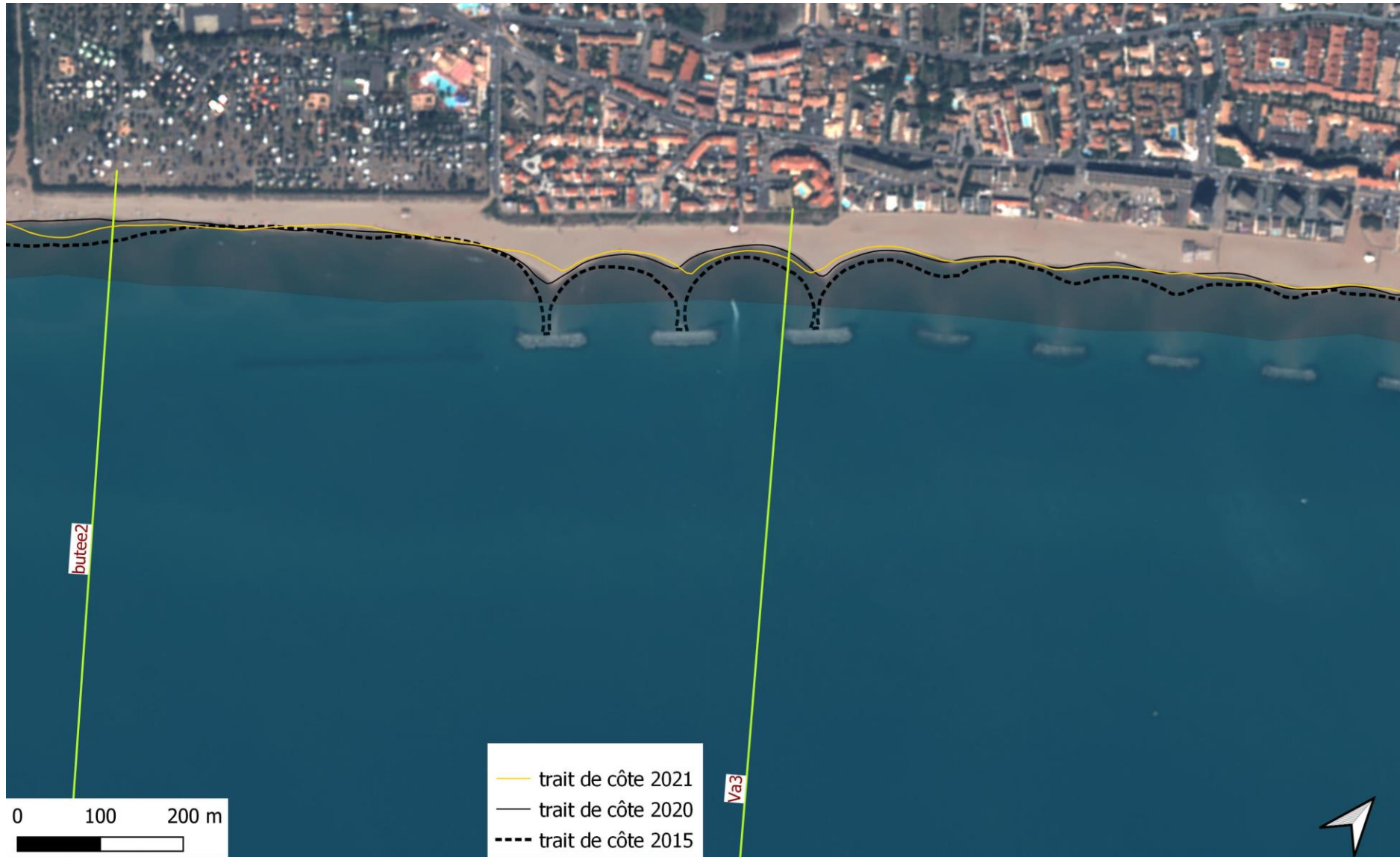
Figure 17 : ortho-image Pléiades de 2020 (commune de Valras) sur la partie ouest du secteur 2, montrant l'évolution du trait de côte entre 2015 (pointillé), 2020 (noir) et 2021 (jaune)
