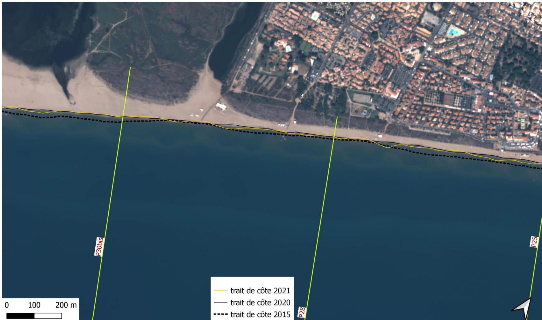
Figure 43 : ortho-image Pléiades de 2020 sur l'ensemble du littoral de Portiragnes, permettant de comparer l'évolution du trait de côte entre 2015 (pointillé), 2020 (noir) et 2021 (jaune)
