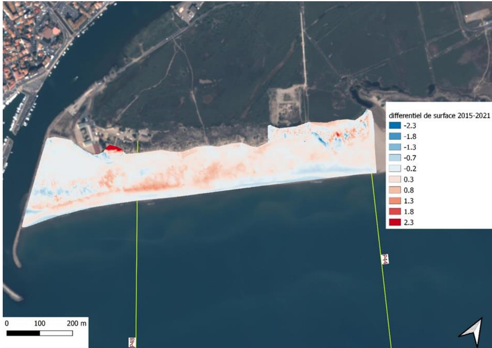
Figure 32 : Evolution du relief sur le MNT topographique des Orpellières côté Valras entre 2015 et 2021
