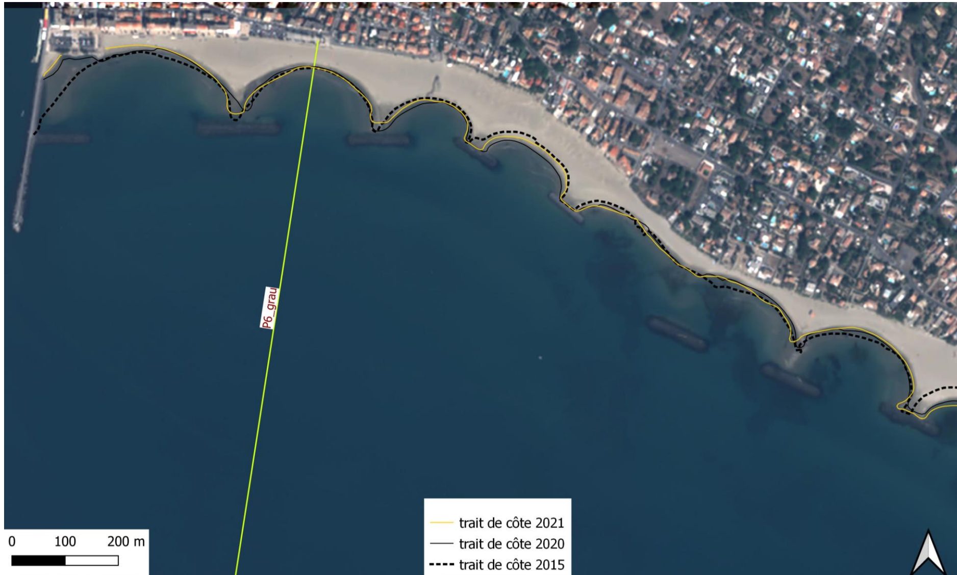
Figure 68 : ortho-image Pléiades de 2020 sur le secteur du grau d'Agde, permettant de comparer l'évolution du trait de côte entre 2015 (pointillé), 2020 (noir) et 2021 (jaune)
