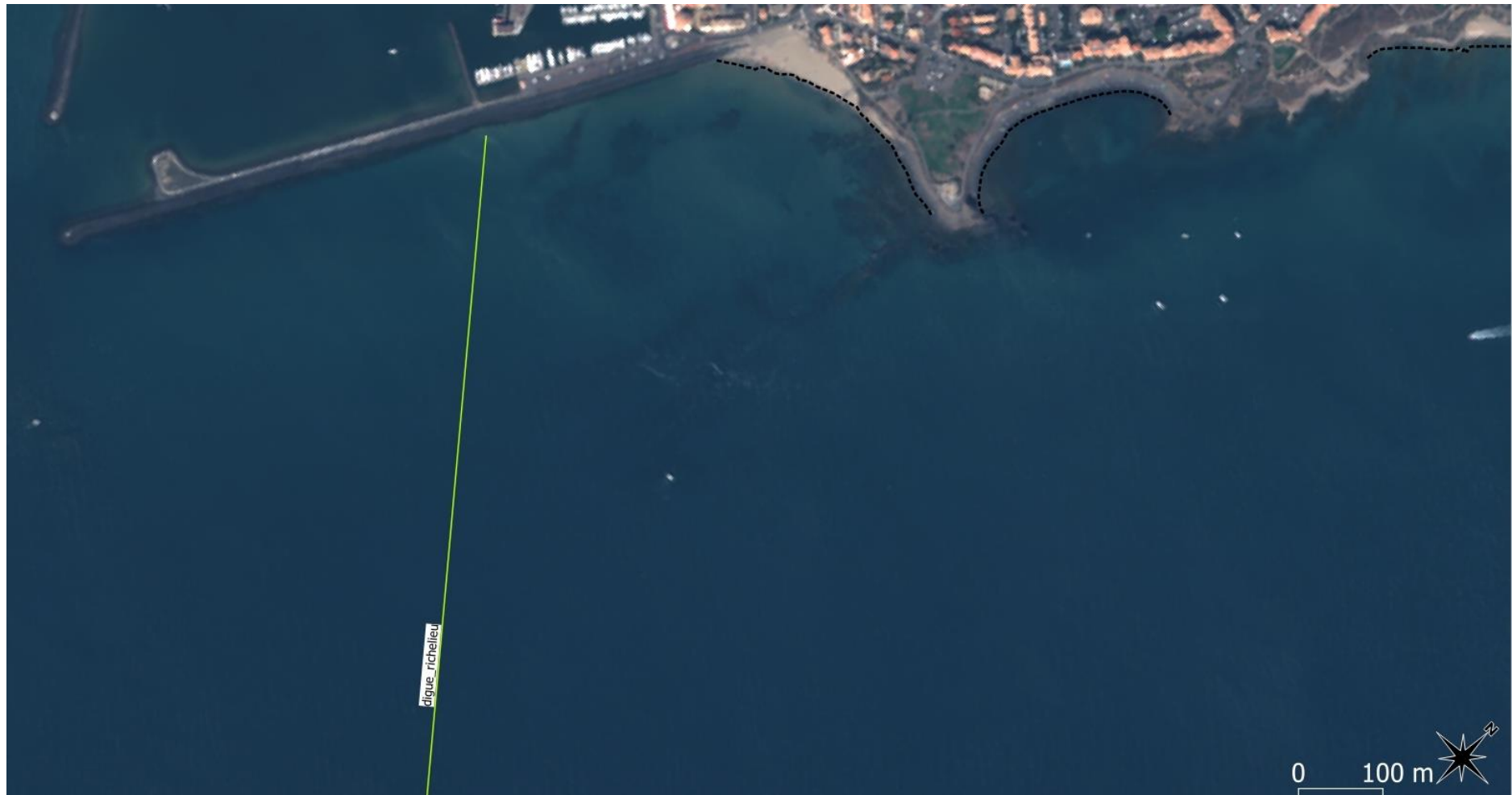
Figure 147 : ortho-photographie 2020 (Pléiades) du secteur 10 (Agde – la Conque) montrant la morphologie de la plage et des barres d'avant-côte (visibles par transparence de l'eau). La position du trait de côte en 2015 est rappelée par un trait pointillé noir.
