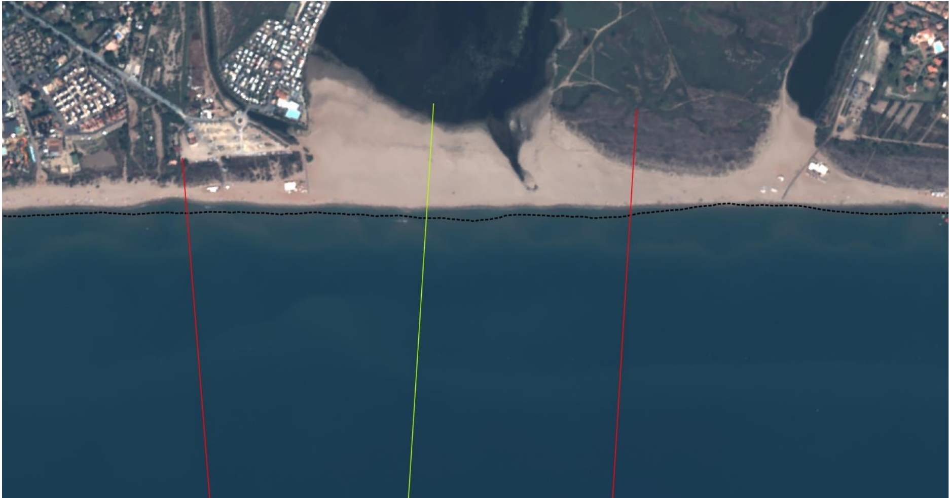
Figure 75 : ortho-photographie 2020 (Pléiades) du secteur 4 (graus de la Maire et de la Riviérette) montrant la morphologie de la plage et des barres d'avant-côte (visibles par transparence de l'eau). La position du trait de côte en 2015 est rappelée par un trait pointillé noir.
