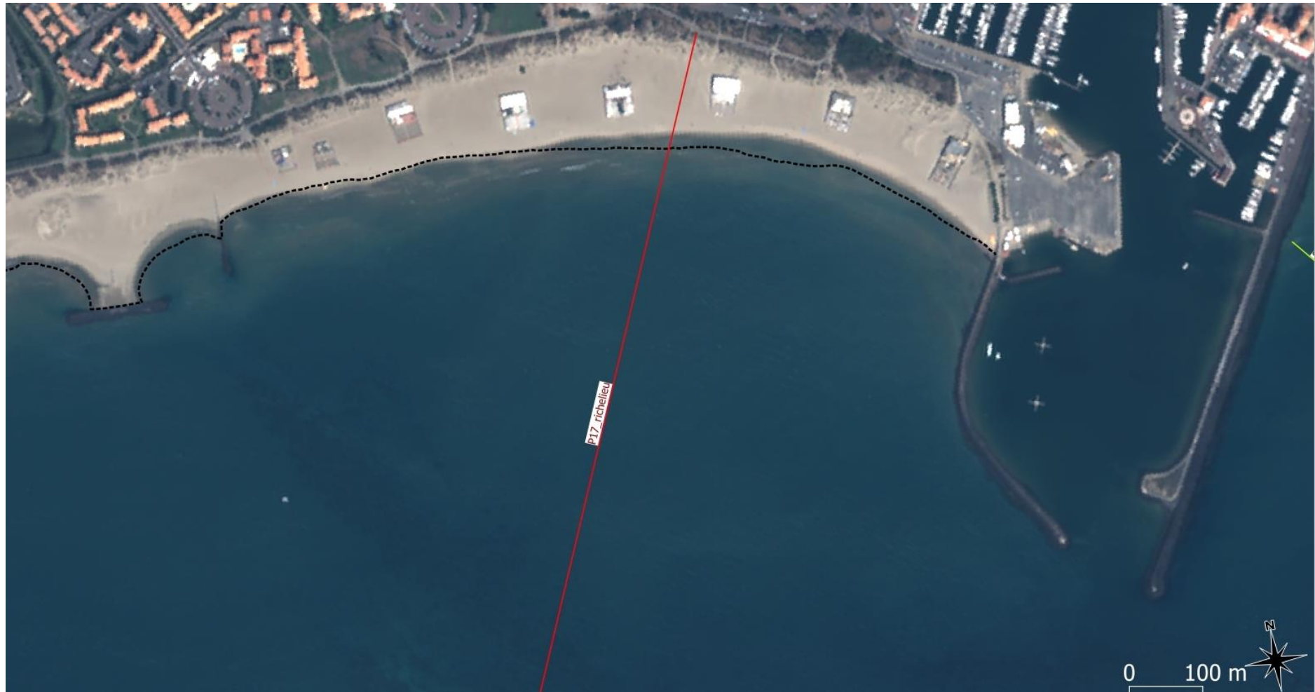
Figure 140 : ortho-photographie 2020 (Pléiades) du secteur 9 (Agde – Richelieu) montrant la morphologie de la plage et des barres d'avant-côte (visibles par transparence de l'eau). La position du trait de côte en 2015 est rappelée par un trait pointillé noir.
