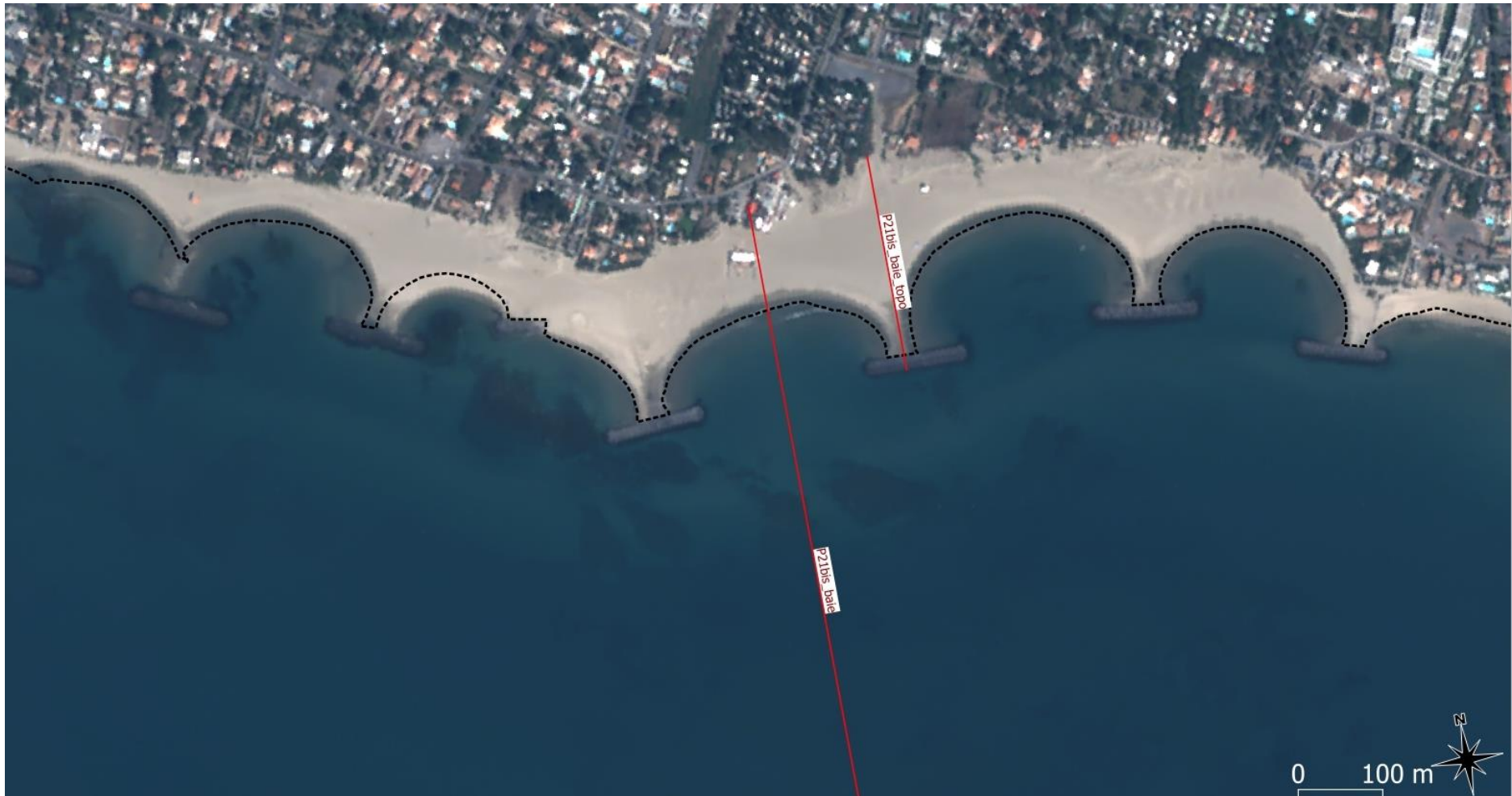
Figure 130 : ortho-photographie 2020 (Pléiades) du secteur 8 (Agde – St Vincent) montrant la morphologie de la plage et des barres d'avant-côte (visibles par transparence de l'eau). La position du trait de côte en 2015 est rappelée par un trait pointillé noir.
