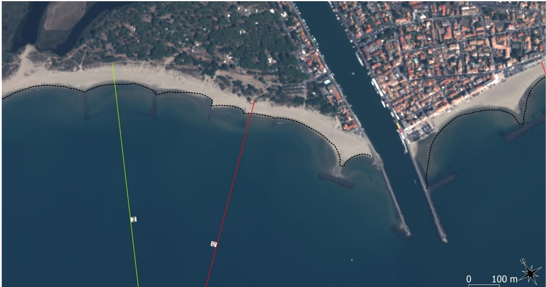
Figure 116 : ortho-photographie 2020 (Pléiades) du secteur 7 (Agde – Tamarissière/Grau d'Agde) montrant la morphologie de la plage et des barres d'avant-côte (visibles par transparence de l'eau). La position du trait de côte en 2015 est rappelée par un trait pointillé noir.
