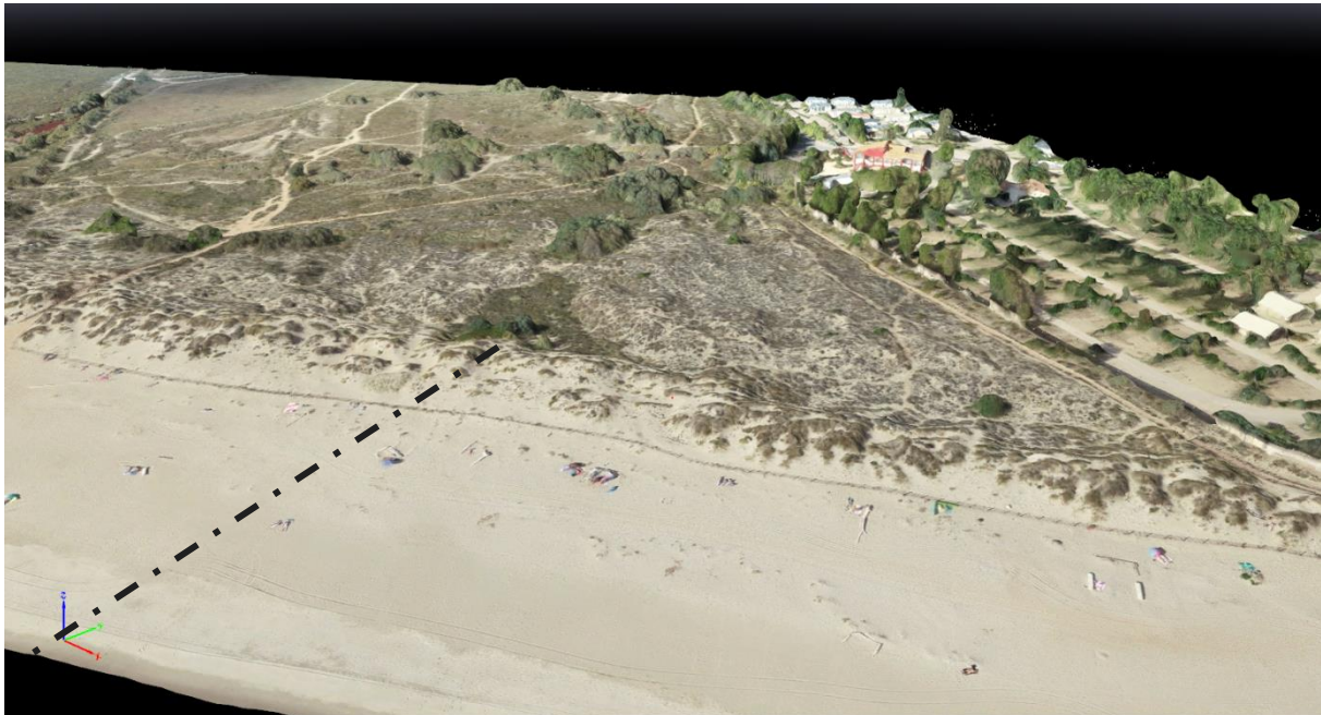
Figure 71 : position du profil P36 par rapport à une modélisation du relief de la dune issu d'un levé réalisé en drone (photogrammétrie) par l'EID en octobre 2019 (© EID, CABM 2019).
