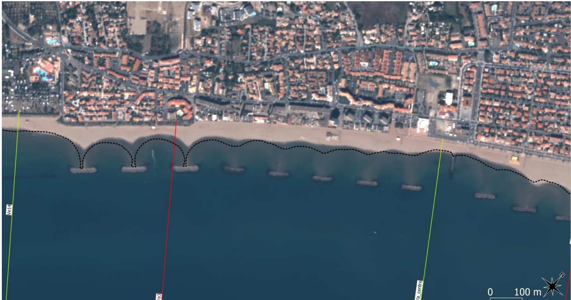
Figure 53 : ortho-photographie 2020 (Pléiades) du secteur 2 (Valras ouest) montrant la morphologie de la plage et des barres d'avant-côte (visibles par transparence de l'eau). La position du trait de côte en 2015 est rappelée par un trait pointillé noir.
