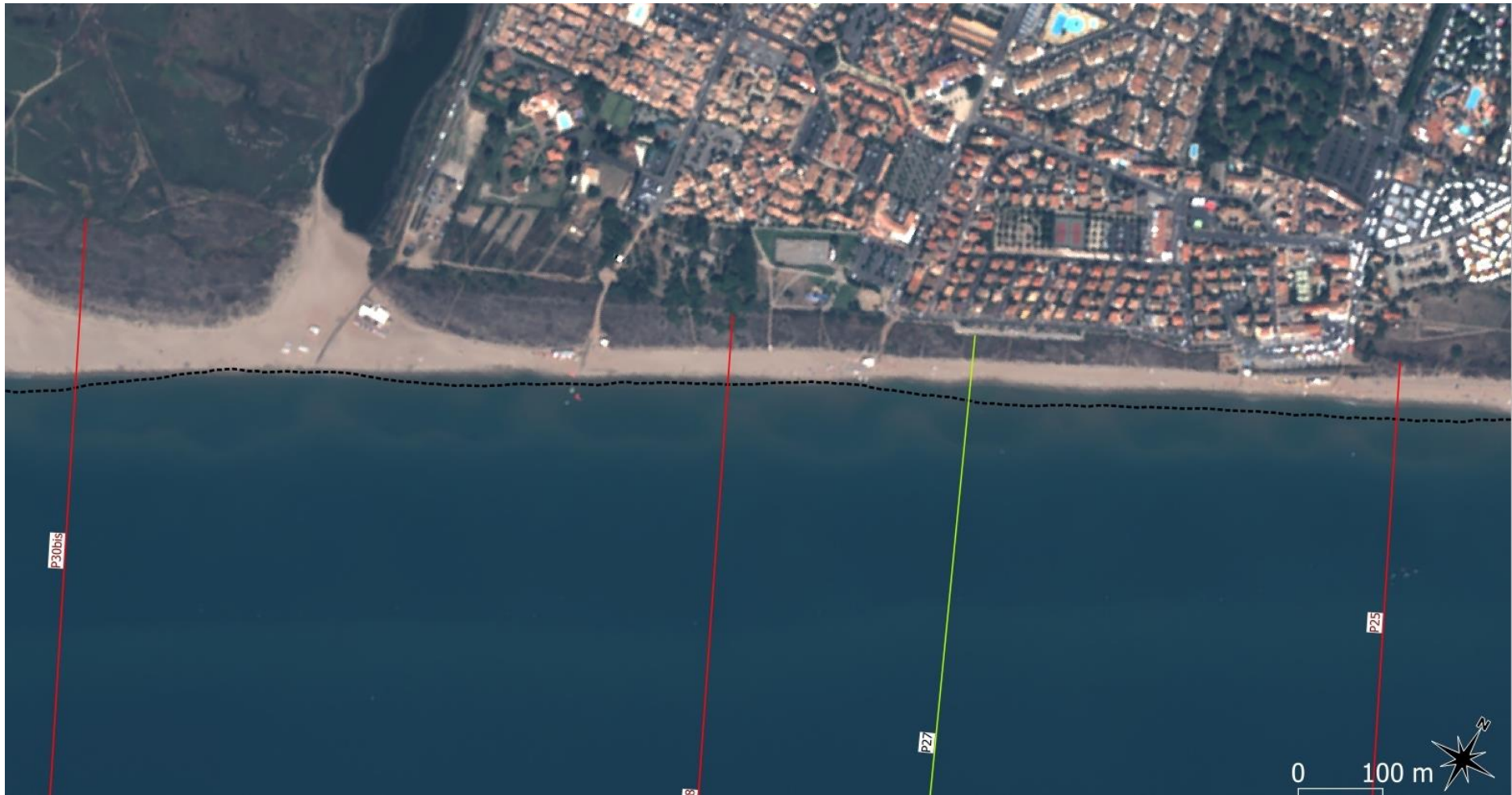
Figure 88 : ortho-photographie 2020 (Pléiades) du secteur 5 (Portiragnes) montrant la morphologie de la plage et des barres d'avant-côte (visibles par transparence de l'eau). La position du trait de côte en 2015 est rappelée par un trait pointillé noir.
