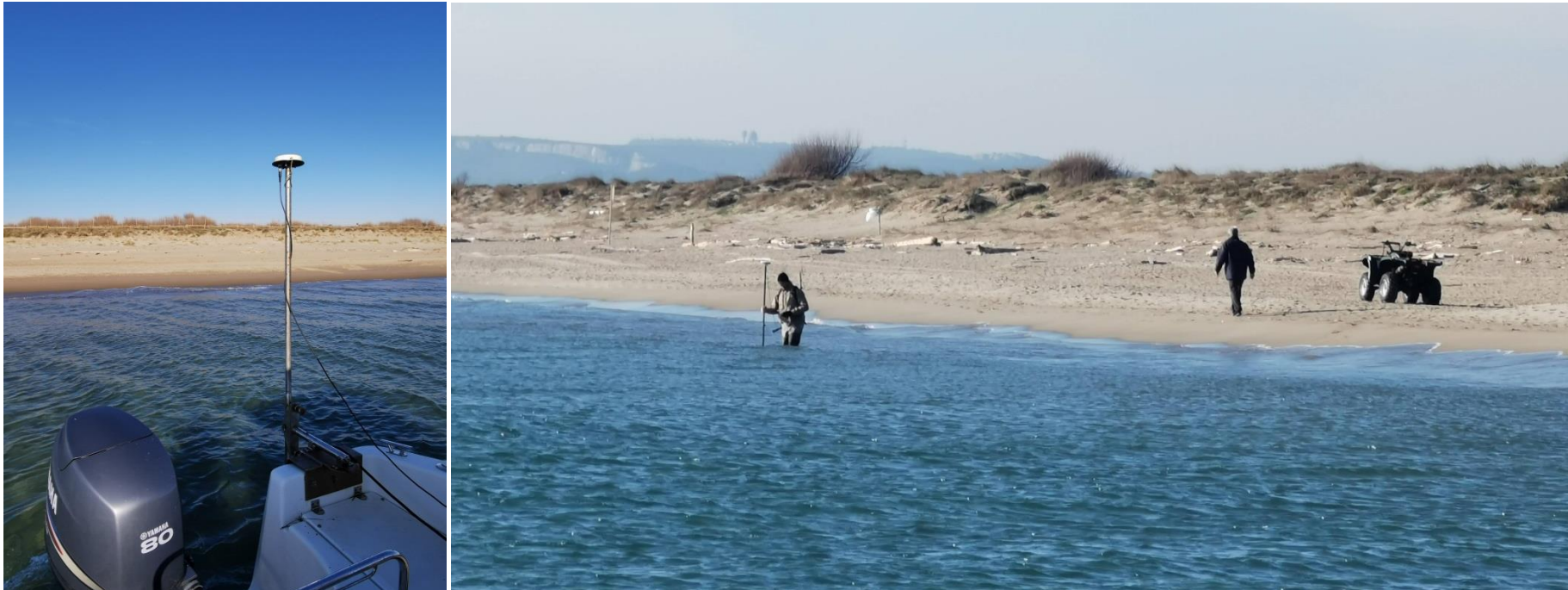
Figure 8 : illustration d'un levé de profil topo-bathymétrique (exemple à Vendres). Une jonction est faite entre les points topographiques et bathymétriques (dans la mesure du possible en fonction du niveau d'agitation de la mer).
