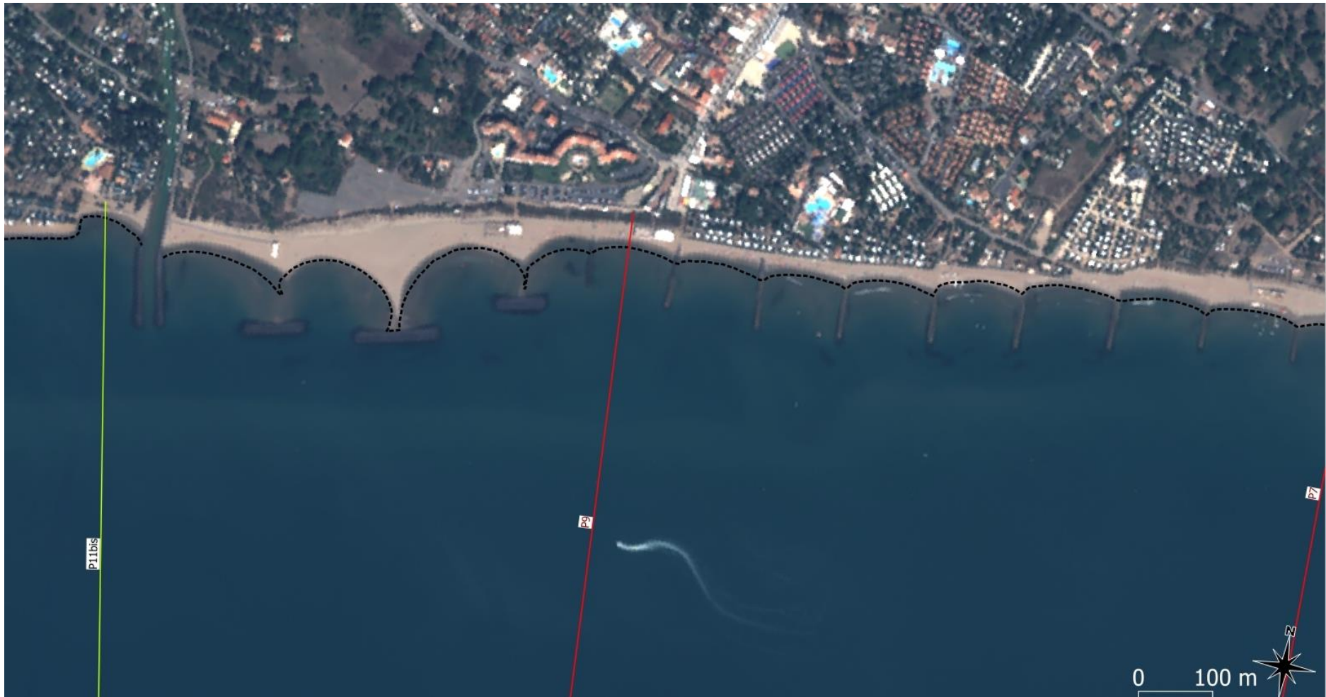
Figure 114 : ortho-photographie 2020 (Pléiades) du secteur 7 (Vias – Farinette) montrant la morphologie de la plage et des barres d'avant-côte (visibles par transparence de l'eau). La position du trait de côte en 2015 est rappelée par un trait pointillé noir.
