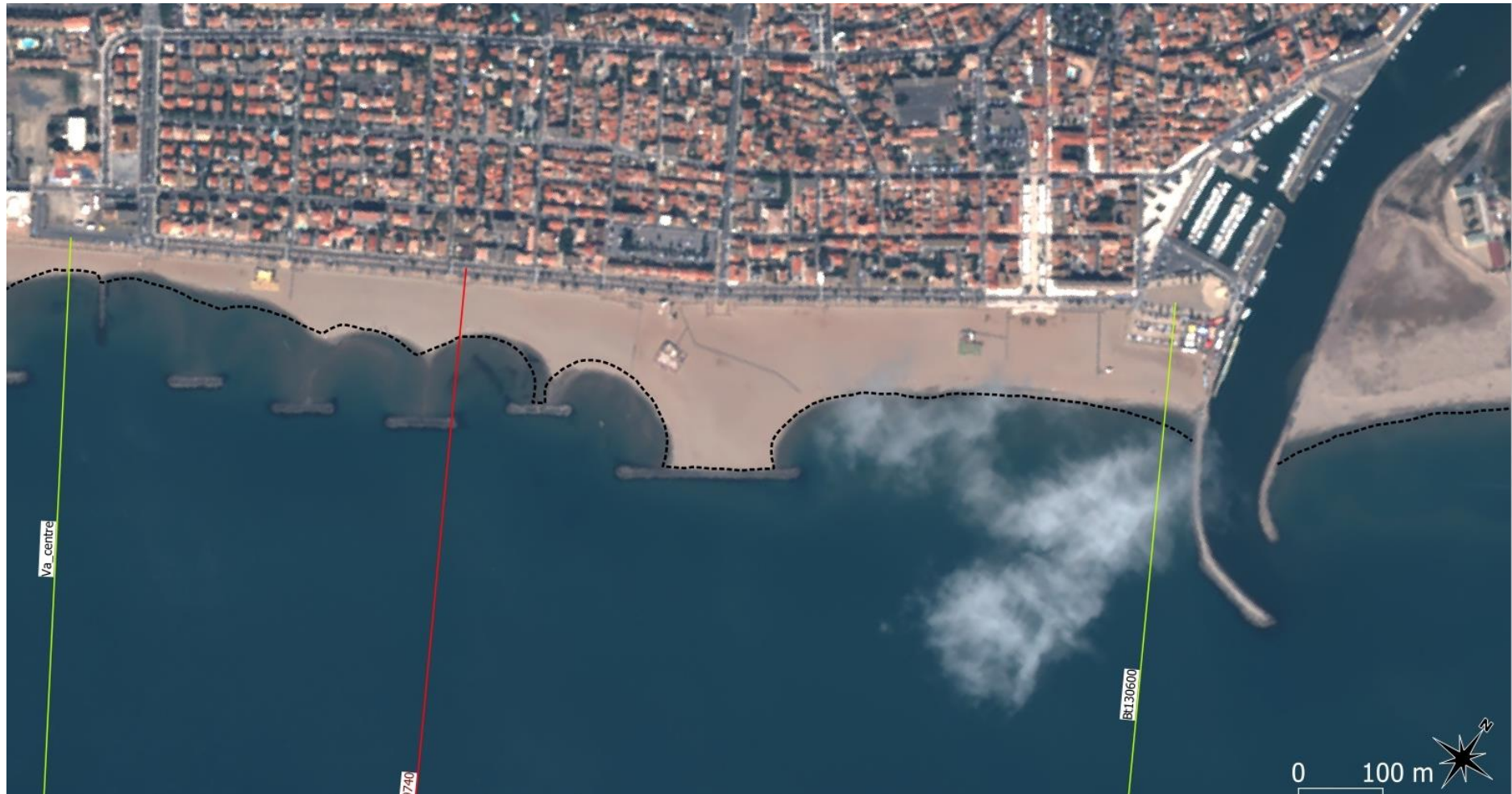
Figure 54 : ortho-photographie 2020 (Pléiades) du secteur 2 (Valras centre) montrant la morphologie de la plage et des barres d'avant-côte (visibles par transparence de l'eau). La position du trait de côte en 2015 est rappelée par un trait pointillé noir).
