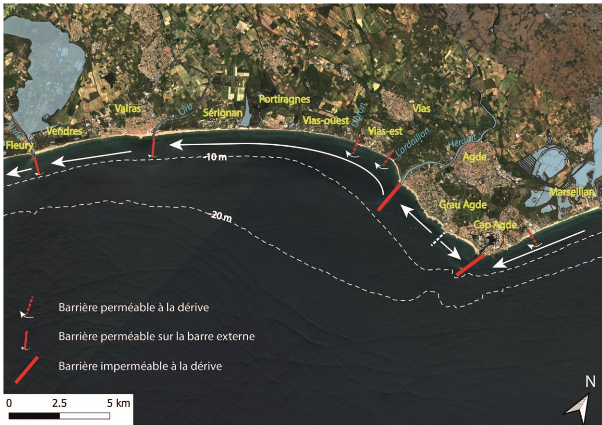
Figure 3 : schéma synthétique des barrières artificielles (ouvrages transversaux) qui entravent de manière plus ou moins marquée le déplacement longitudinal des sables sous l'action de la dérive littorale (flèches blanches).
