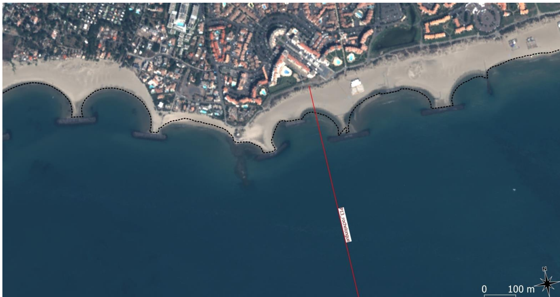
Figure 139 : ortho-photographie 2020 (Pléiades) du secteur 9 (Agde – Rochelongue) montrant la morphologie de la plage et des barres d'avant-côte (visibles par transparence de l'eau). La position du trait de côte en 2015 est rappelée par un trait pointillé noir.
