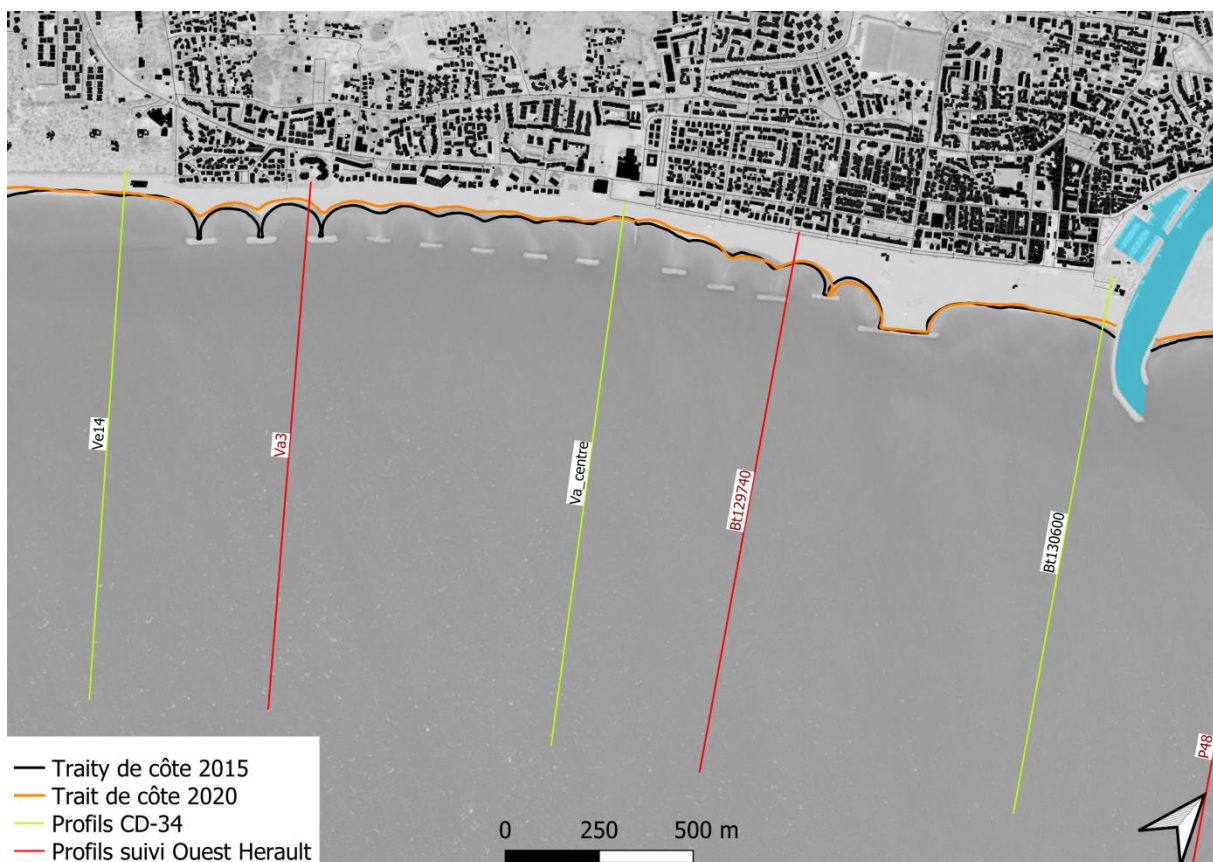
Figure 52 : carte générale du secteur 2 de Valras-Plage zone "urbaine", montrant le recul général du trait entre 2015 et 2020 et la position des profils topo-bathymétriques suivis (profils : Va3, Va-centre, Bt129740, et Bt130600)
