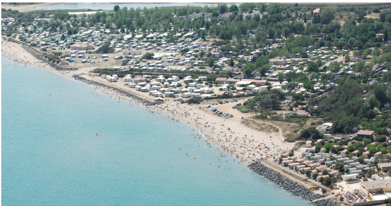
Figure 31 : illustration de la situation ancienne à Vias-ouest avec des enrochements devant le parking du camping GCU, (visibles sur la moitié gauche de la photographie ; © photo EID / CD-34, 2012)
