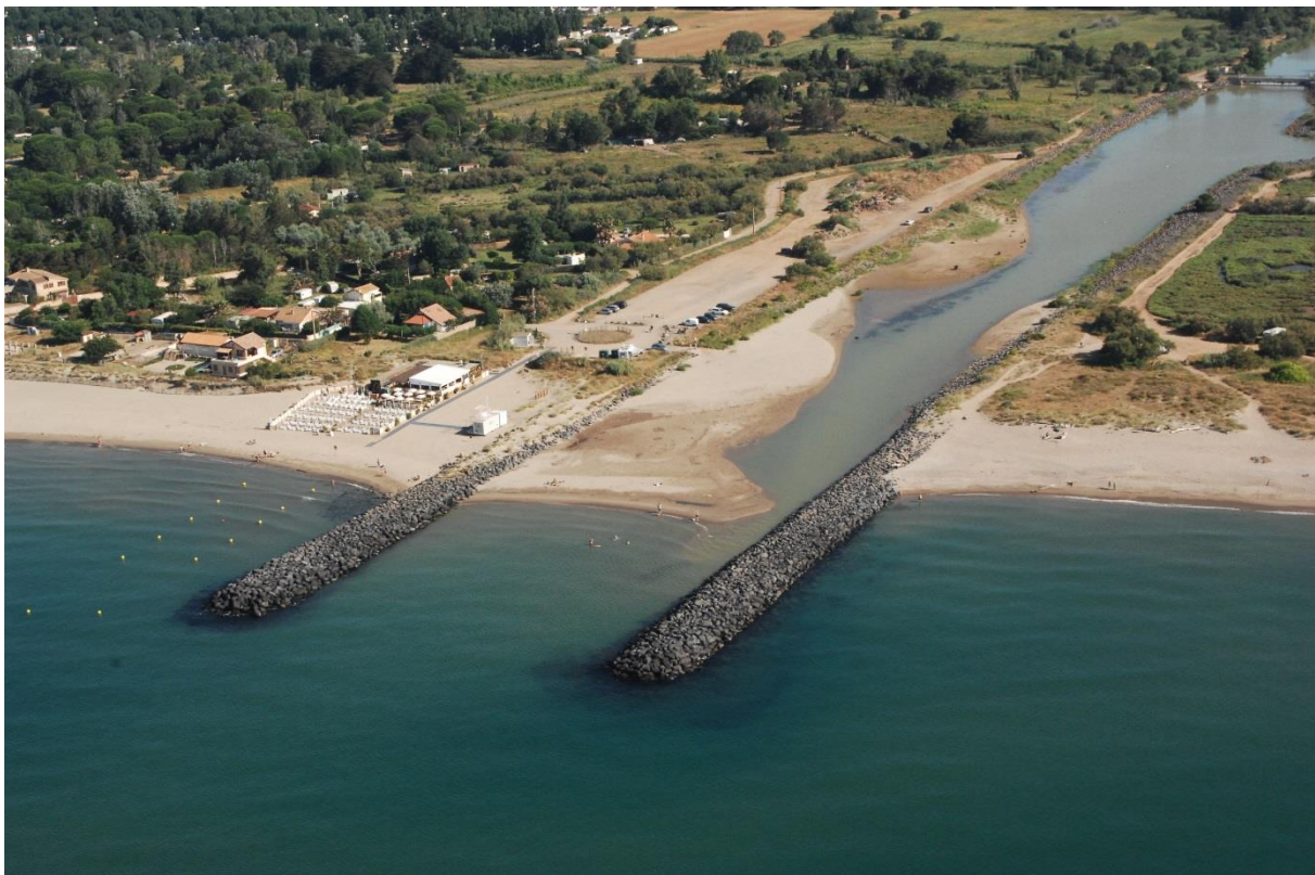
Figure 40 : image aérienne du chenal de l'Ardailon le 27 juin 2018, montrant son fort ensablement (© photo EID / CD-34)
