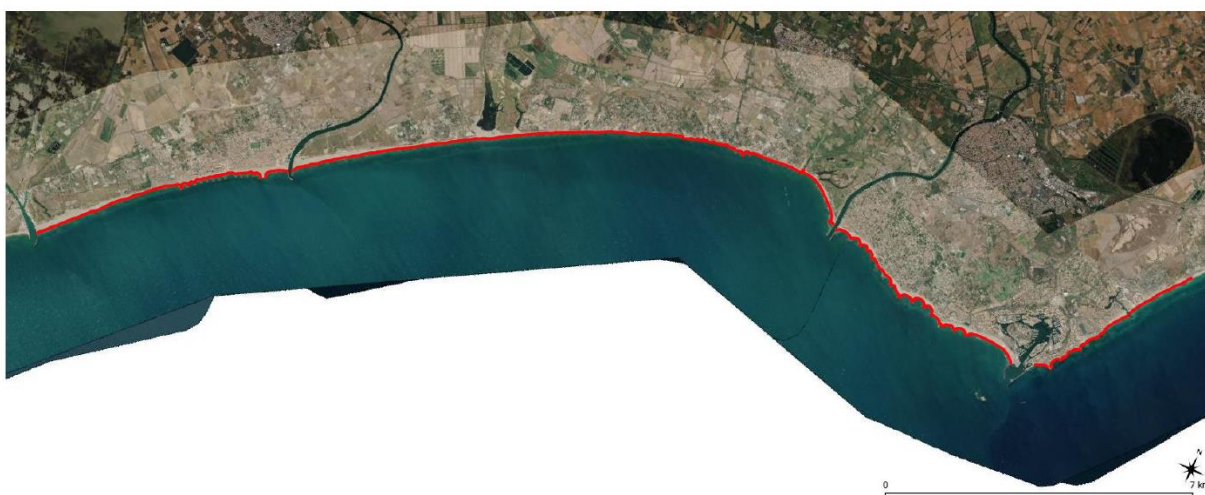
Carte présentant l'acquisition au DGPS du trait de côte en 2020 (EID 2020 pour le CD34, CAHM, CABM et CC La Domitienne)
