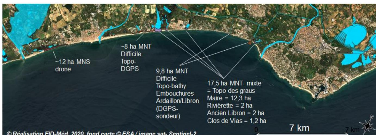
Carte présentant la localisation des MNT et MNS réalisés en 2020 (EID 2020 pour le CD34, CAHM, CABM et CC La Domitienne)
