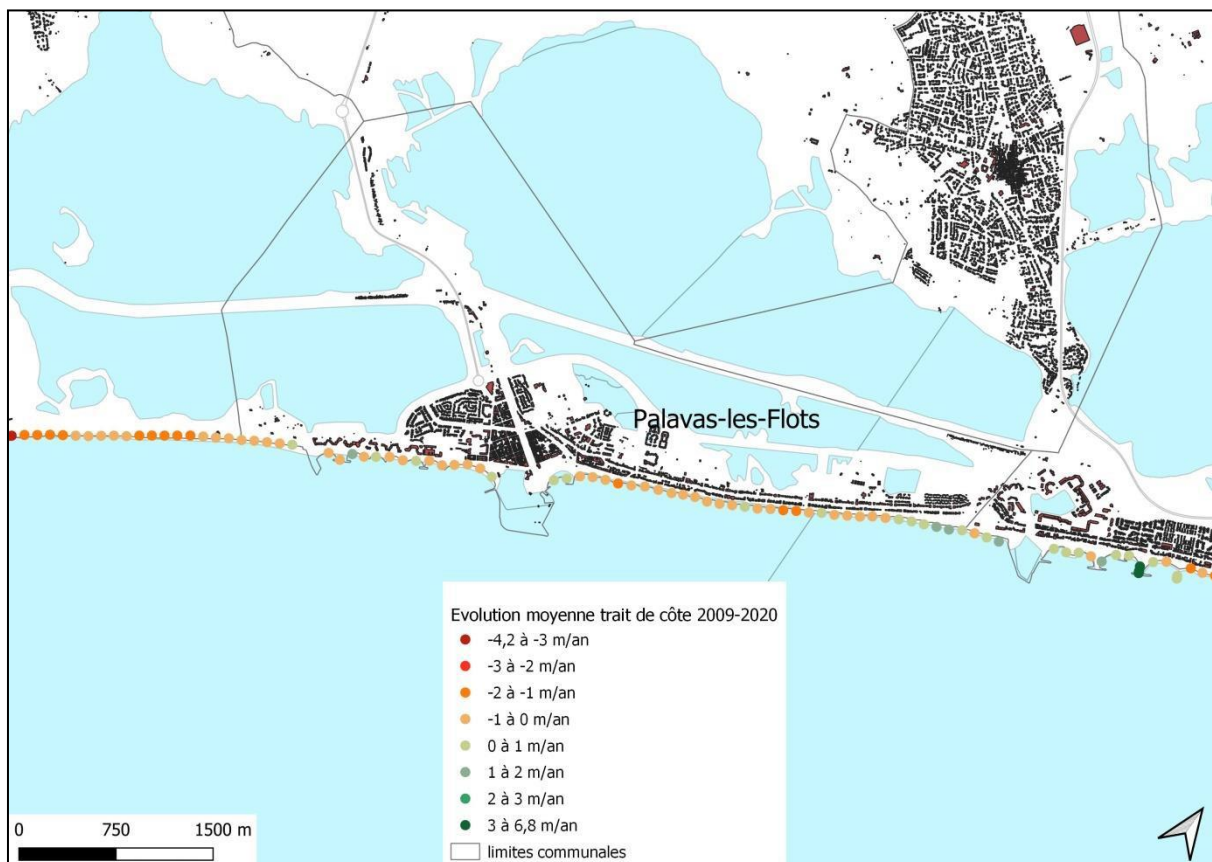
Evolution de la position du trait de côte entre 2009 et 2020 sur la commune de Palavas les Flots selon la méthode DSAS
