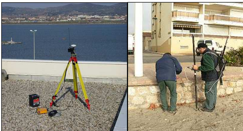
Station fixe, surélevée, pour une meilleure émission (à gauche) - Prise de point à la canne par les techniciens de l'EID-Méditerranée (à droite)
