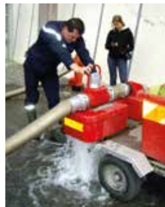
Essai d'un poteau incendie (source : Irstea)
