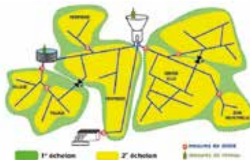
Principe de la sectorisation du réseau (sources : Agence de l'eau Adour-Garonne, OIEau, SMEGREG)
