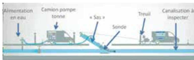
Inspection par champ lointain à l'aide de la sonde Inspect'O® (source : Aquadiag Solutions)
