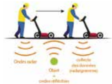
Principe de la géodétection (source : I.D.R.S)
