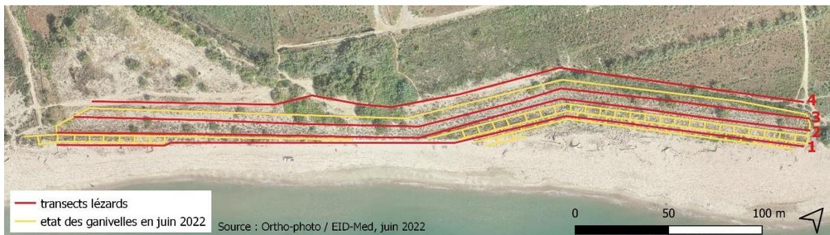
Figure 7 : Modification du transect 1 suite à la tempête de mars 2022 ayant impacté l'ouvrage (EID-Méd. 2022)
