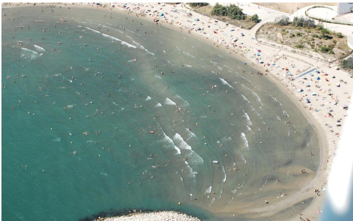
Secteur du Point Zéro, été 2012 ; zone d'accumulation sableuse à proximité d'un brise-lames ; le déferlement sur le système de barres est bien visible ; à l'arrière le cordon dunaire est tronçonné par de nombreux accès-plage relativement larges.
