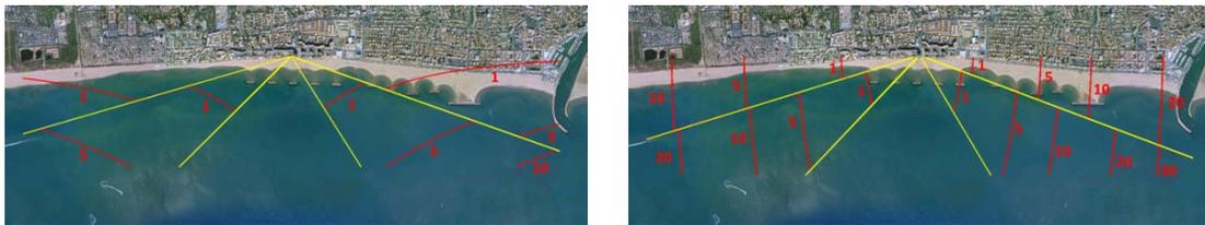
Figure 20 : Cartes de résolution transversale (a) et longitudinale (b) de la station vidéo de Valras-Plage, 2<sup>ème</sup> configuration
