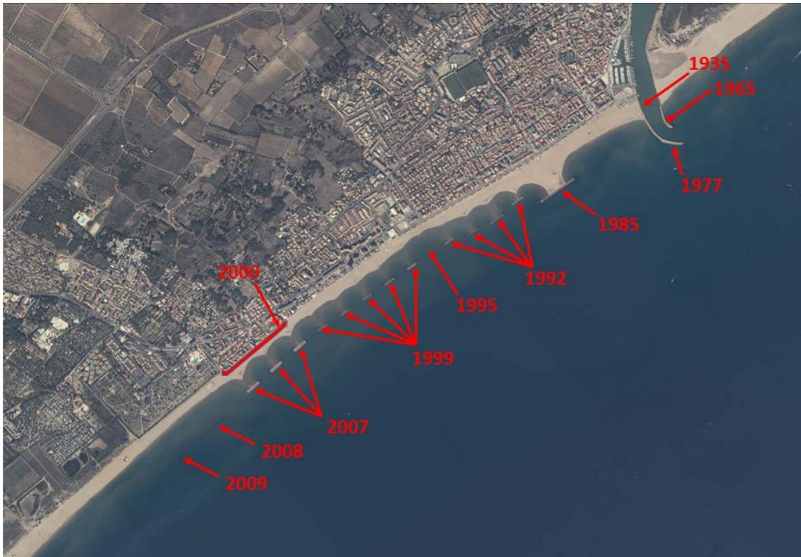
Figure 10 : Descriptif de l'implantation des structures de protection côtière sur le littoral de Valras-Plage. (Orthophotographie IGN)
